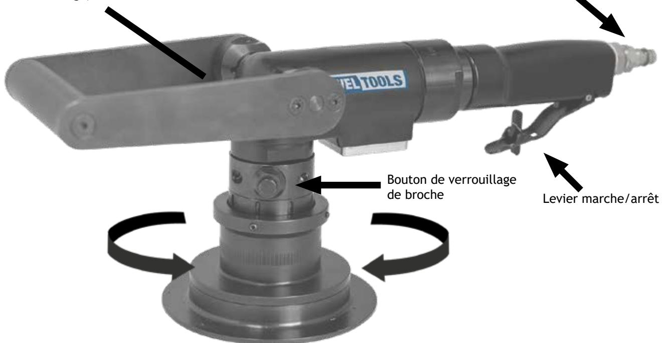
Tourner la base dans le sens anti-horaire pour diminuer la profondeur de coupe et dans le sens horaire pour l'augmenter.
