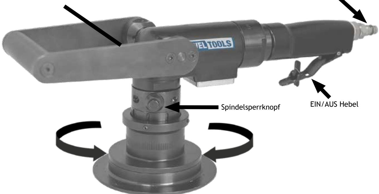
Drehen Sie die Basis gegen den Uhrzeigersinn, um die Schnitttiefe zu verringern, und im Uhrzeigersinn, um sie zu erhöhen.
