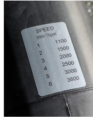
N'augmentez jamais la vitesse de rotation sélectionnée pour l'outil de fraisage pendant le fonctionnement !
