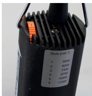
N'augmentez jamais la vitesse de rotation sélectionnée pour l'outil de fraisage pendant le fonctionnement !
