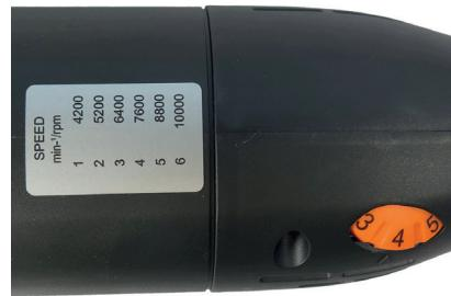
N'augmentez jamais la vitesse de rotation sélectionnée pour l'outil de fraisage pendant le fonctionnement !
